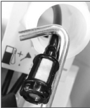
Рис. 17 Извлечение топливного фильтра
