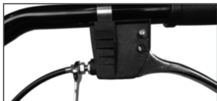
Рис. 9 Установка регулировочной муфты троса газа
