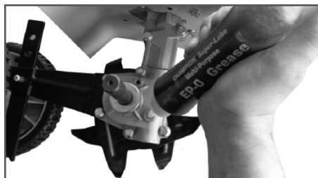
Рис. 20 Добавление смазки в корпус редуктора
