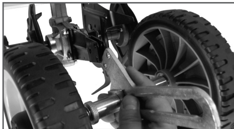
Рис. 6 Установка кронштейна колес
