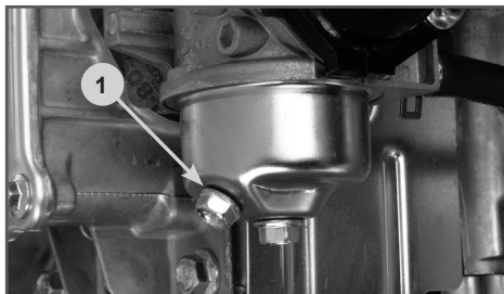
Рис. 14 Слив топлива из карбюратора
