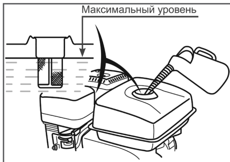
Рис. 5 Максимальный уровень топлива в топливном баке
