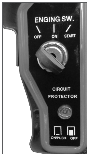
Рис.7 Замок зажигания и предохранитель
