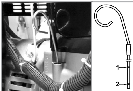
Рис. 8 Проверка уровня масла в картере
