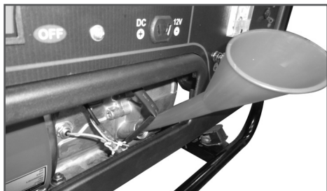
Рис. 7 Заправка масла в картер двигателя
