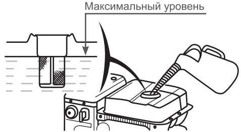
Рис. 3 Максимальный уровень топлива в топливном баке
