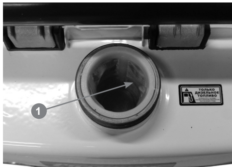
Рис. 9 Максимальный уровень топлива в топливном баке
