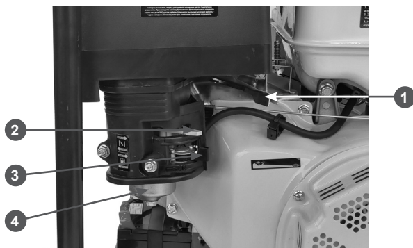
Рис. 4 Органы управления двигателя (вид на карбюратор)
