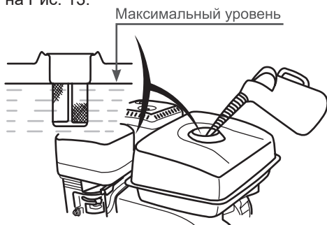
Рис. 13 Максимальный уровень топлива в топливном баке
