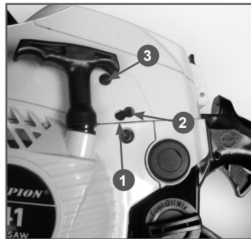
Рис. 20 Винты регулировки карбюратора 1 - винт «L», 2 - винт «H», 3 - винт «T»
