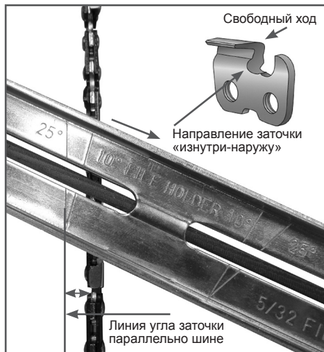
Рис.18 Определение угла заточки
