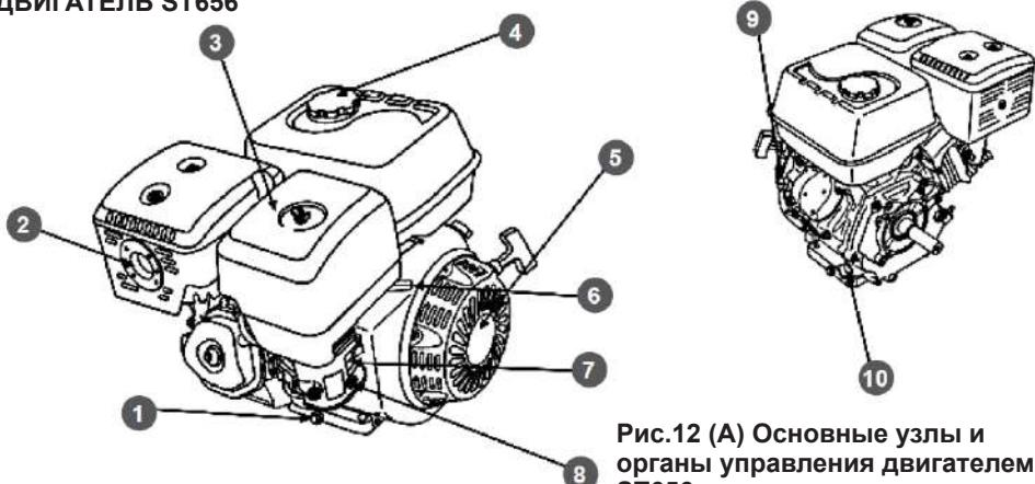
**Рис.12 (А) Основные узлы и органы управления двигателем ST656**
